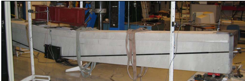
Figur 2 Typisk spännlinekonfiguration under referensbalksförsök
