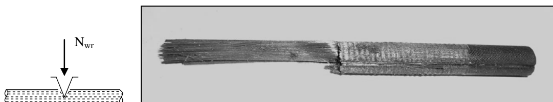
Figur 4 Principen bakom och utseendet orsakat av tidigt brott på grund av gängade kilar
